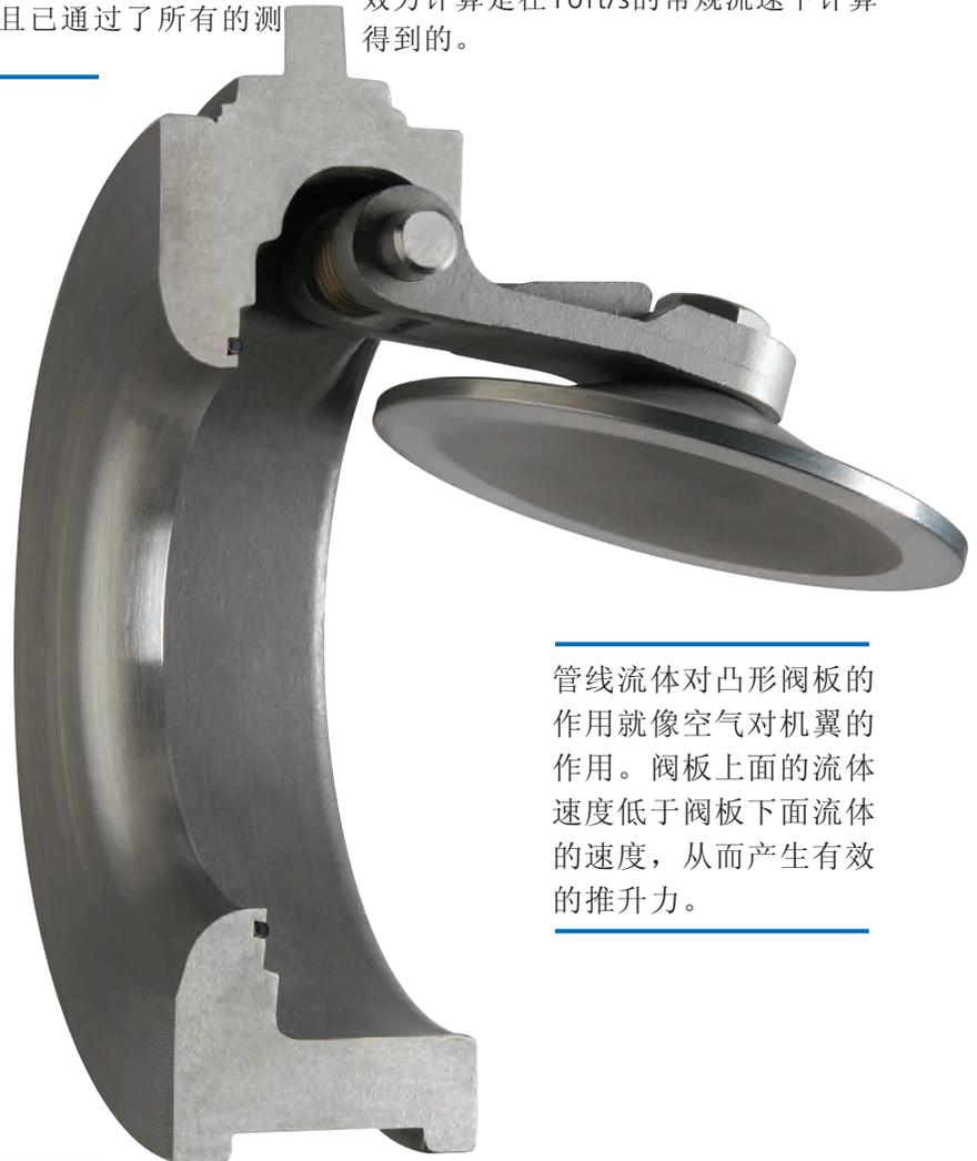
管线流体对凸形阀板的作用就像空气对机翼的作用。阀板上面的流体速度低于阀板下面流体的速度，从而产生有效的推升力。
