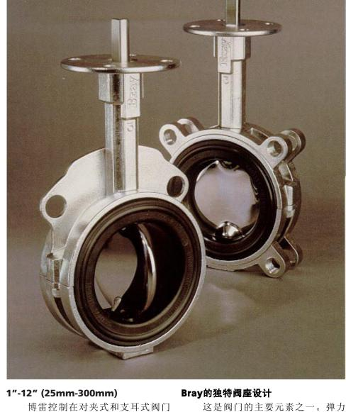
中提供新的两片式316不锈钢阀体。 1"-1-1/2"阀门为对夹式阀体 2"-12"阀门为对夹式和支耳式阀体 1"-6" 阀门为精密铸造阀体 8"-12" 阀门为砂磨铸造 这种特殊系列阀门具有在严酷环境下 表面高度抗腐蚀的特殊优势。
