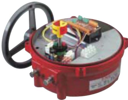
可选择的由微处理器控制伺服器根据模拟输入信号可提供准确的阀门位置的调节控制。伺服装置可按照标准提供一个与阀门实际位置成比例的模拟输出信号，这一模拟信号可以转化成电流或电压输出并带动载重为250-Ohm的负载无需额外提供电力。输入信号为4-20mADC,0-10VDC,0-5VDC,或电位计135Ohms或更大。所有输入伺服器的电压均有保护，包括电力传送输入。伺服
