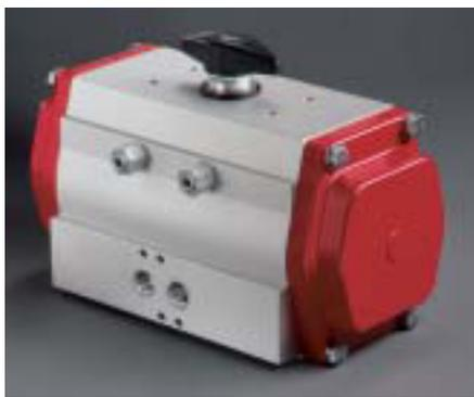
所有92/93系列执行机构气孔为标准NAMUR界面。此外，博雷执行机构符合ISO5211和VDI/VDE3845 (NAMUR推荐使用)标准尺寸，无需使用额外连接支架即可直接安装在博雷阀门上。标准的执行机构外壳为经氧化处理的挤压铝，两个端盖上是红色聚酯涂层。不锈钢的执行机构外壳和化学镀镍涂层的铝外壳也是可以选择的。
