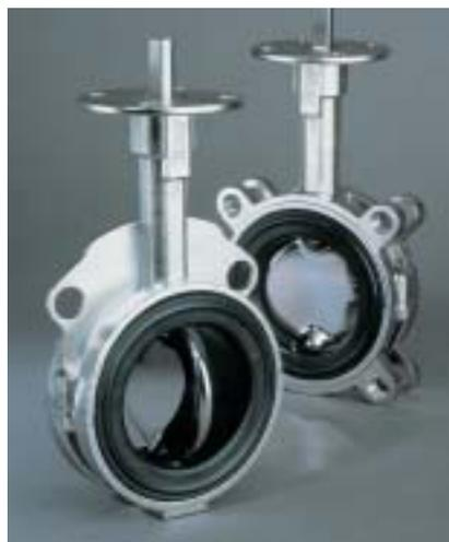
压力为50psi(3.5bar)。可拆分式的阀体设计使得阀座更换简单、快捷。316不锈钢阀体有对夹式和支耳式两种。1"-6"为铸造，8"-12"为沙铸。20/21系列阀门采用316不锈钢或哈氏合金为阀板/阀杆材料，阀座材料包括PTFE和弹性橡胶。
